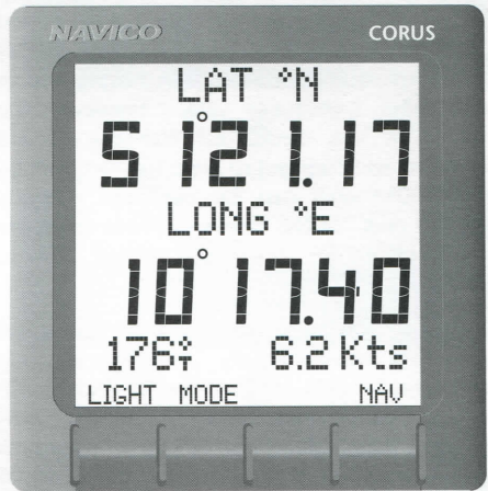
Fig 2.4 - C700DC Datacentre Display
